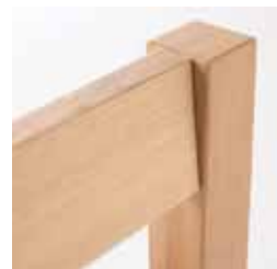
将切割后的剩余板材进行贴合,制成坚固的方木料。
